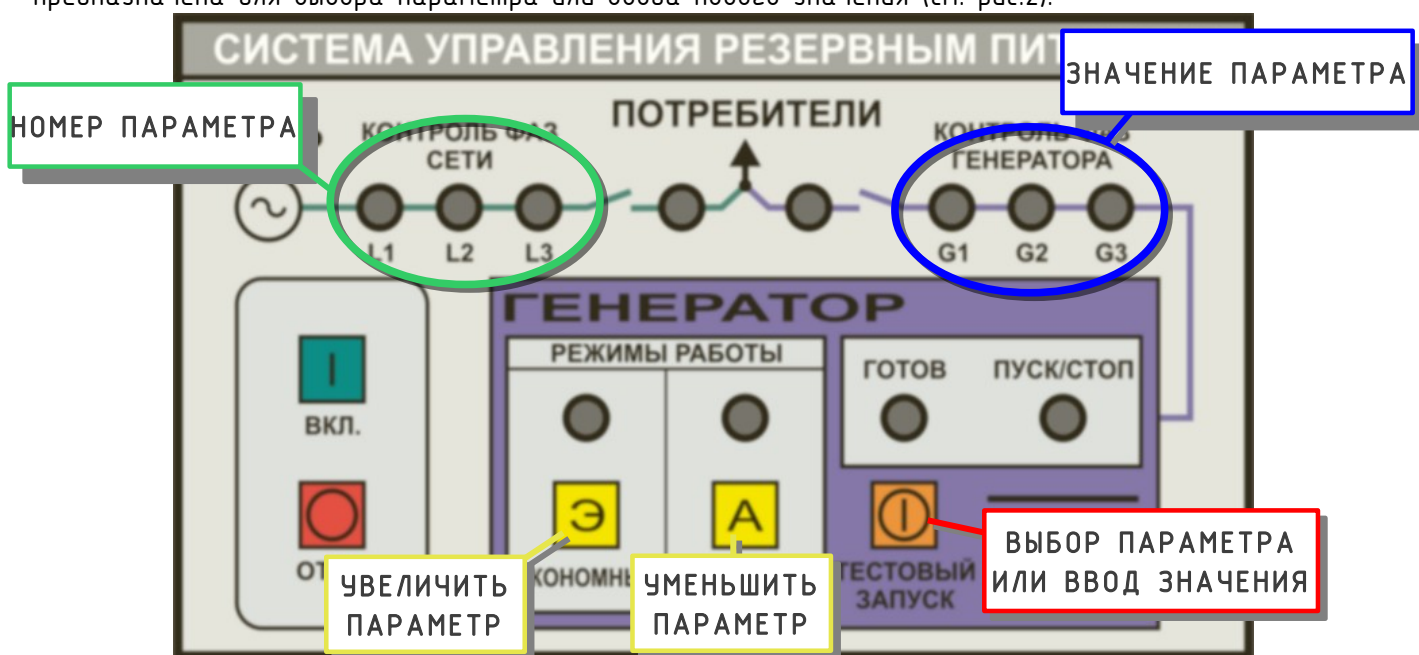
Рис.2. Назначение кнопок и индикаторов в режиме изменения настроек.
