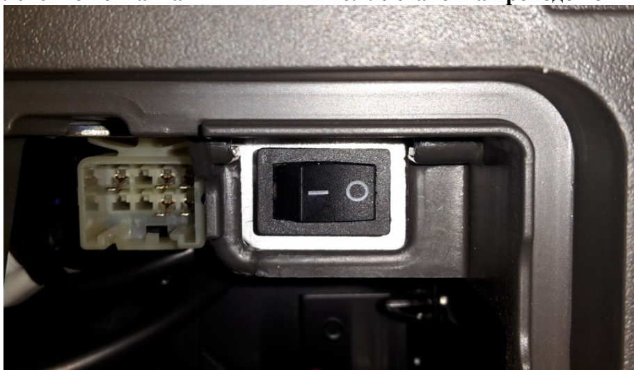
Рис.5. Установка переключателя режима работы.
