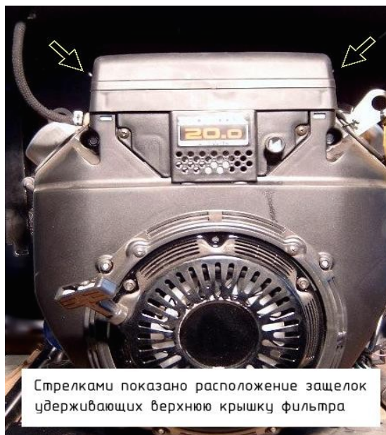
Рис. П2.2. Снятие фильтра на GX620.
