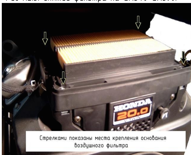
Рис.П2.5. Снятие фильтра на GX620.
