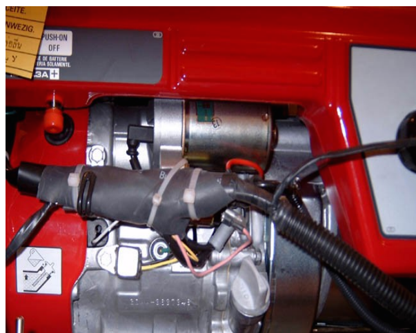
Рис.П2.16. Пример заделки жгута после монтажа.
