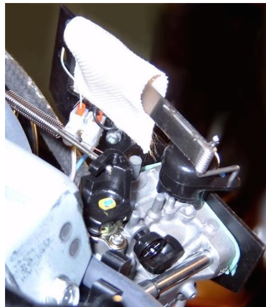
Рис.П2.7, П2.8. Вид на установленный электропривод GX340–GX390 (с вакуумным клапаном).
