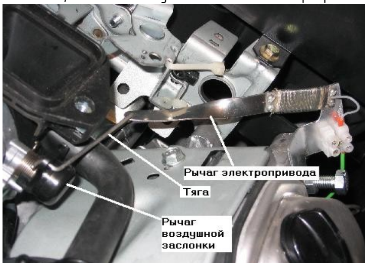
Рис. П2.9. Вид на установленный электропривод GX620. Рис. П2.10. Крепление привода GX620.
