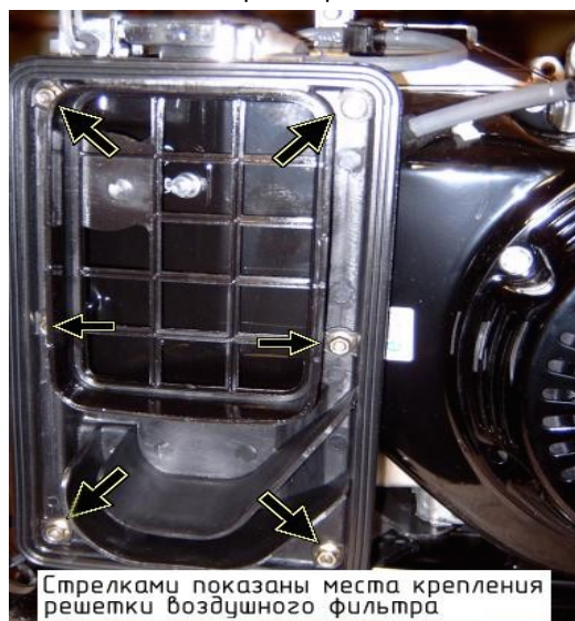
Рис. П2.3. Снятие фильтра на GX340-GX390.
