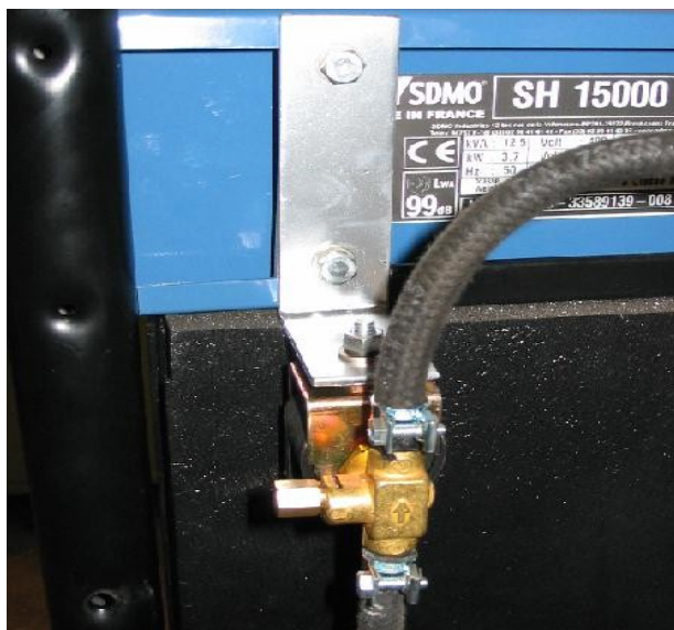
Рис. П2.13. Пример крепления бензозапанана на генераторной станции EP6500S
