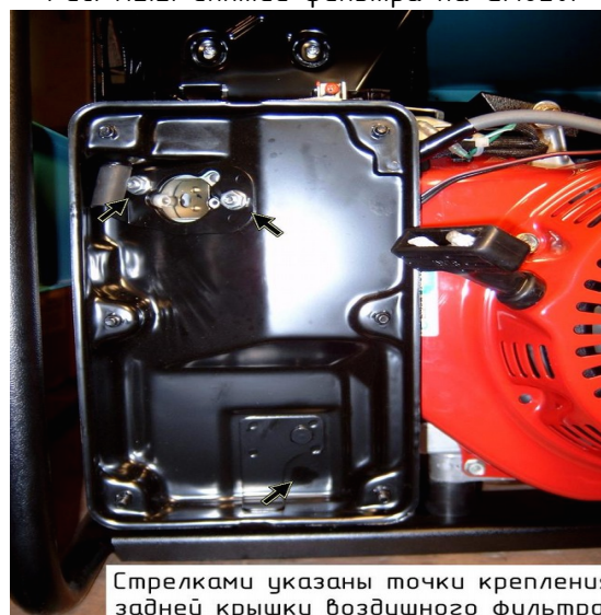
Рис. П2.4. Снятие фильтра на GX340-GX390.
