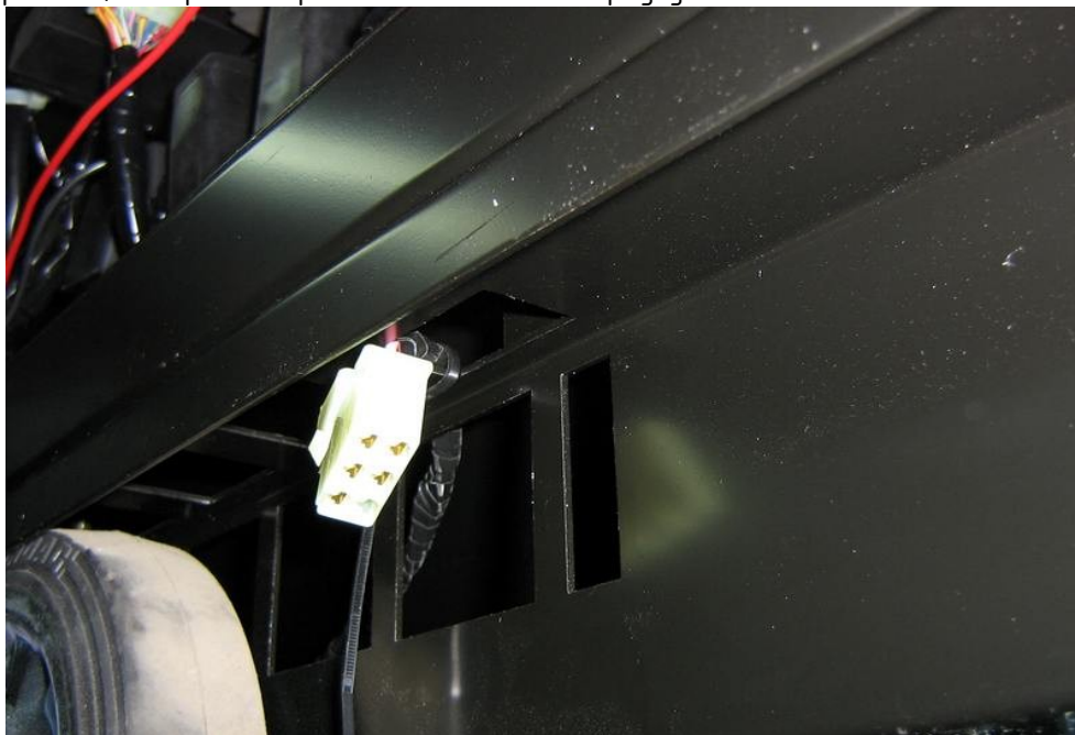
Рис. П2.2. Вывод и крепление разъёма для подключения кабеля ДУ.
