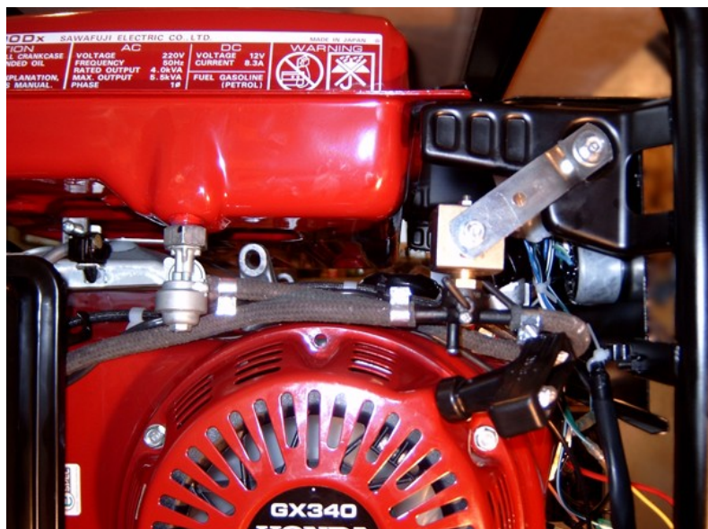
Рис. П1.6. Крепление бензоклапана на генераторных станциях HONDA и ELEMEX.
