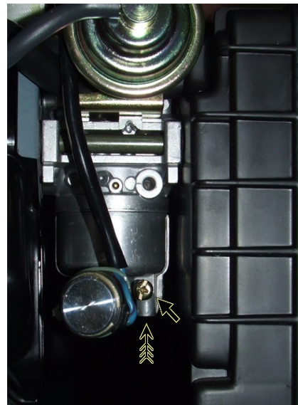
Рис. ПЗ.1 и ПЗ.2. Ликвидация воздушной пробки в двигателях GX240–GX390 и ГС YAMAHA.
