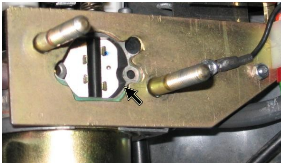
Рис. П2.10. Проверка зазора (показан стрелкой).
