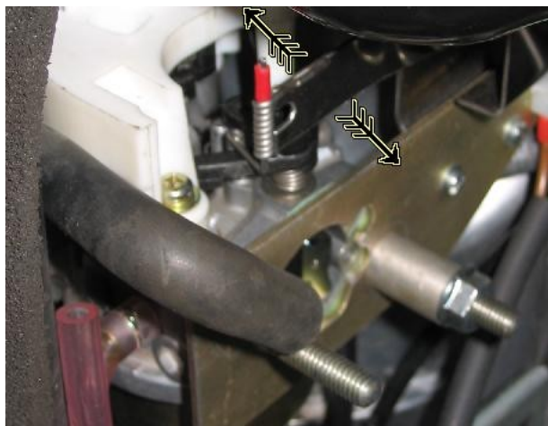
Рис. П2.11. Направления подстройки заслонки.
