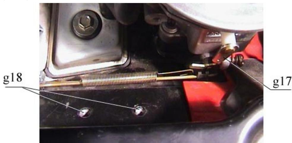
Рис.10. Вид рычага управления заслонкой в разобранном виде.
