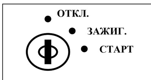
Рис.21. Положение замка зажигания.
