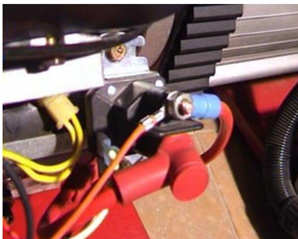
Рис.18. Подсоединение проводов к реле стартера.
