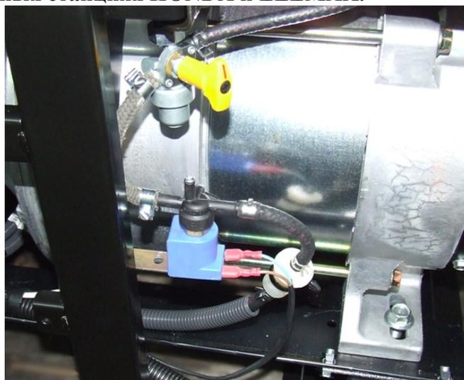
Рис.П1.13. Крепление бензинового клапана на ГС SH11000 и SH15000 фирмы ELEMАX.
