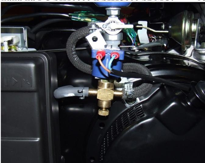
Рис.П1.12. Крепление бензинового клапана на генераторной станции YAMAHA EF6600E.
