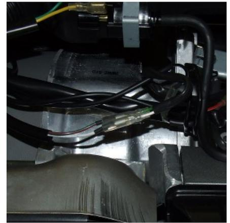
Рис.П1.7.Схема подключения. Рис.П1.8.Вывод на двигателях Honda GX240-GX390 и аналогах. П1.9.Вывод на ГС«Yamaha».
