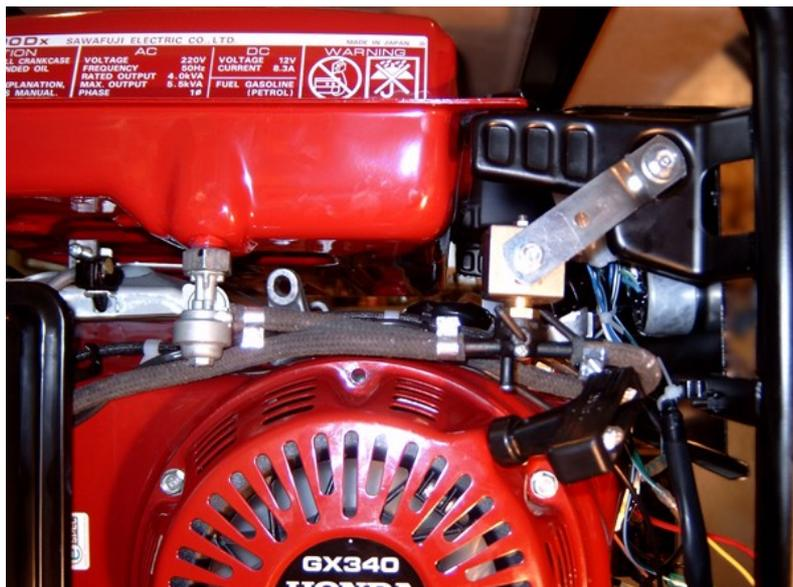
Рис. П1.11. Крепление бензоклапана на генераторных станциях HONDA и ELEMАX.
