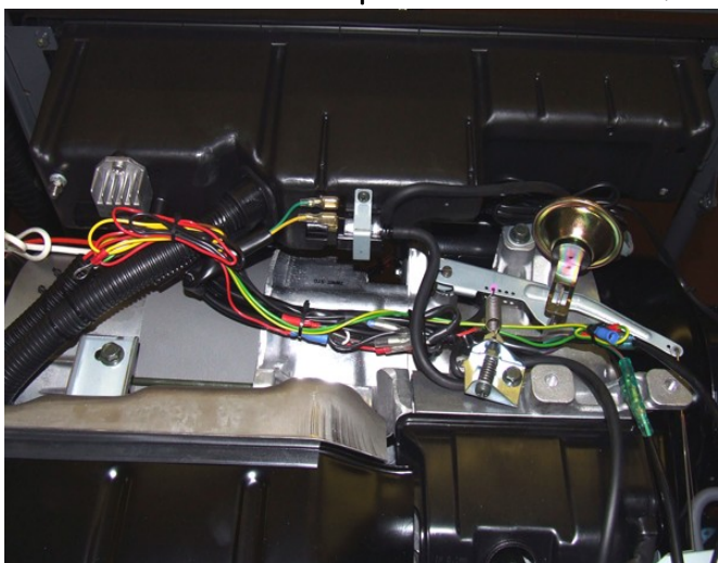
Рис.П1.8 и Рис.П1.9. Примеры оформления жгута после подключения на ГС серии EF5200E и EF6600E фирмы Yamaha
