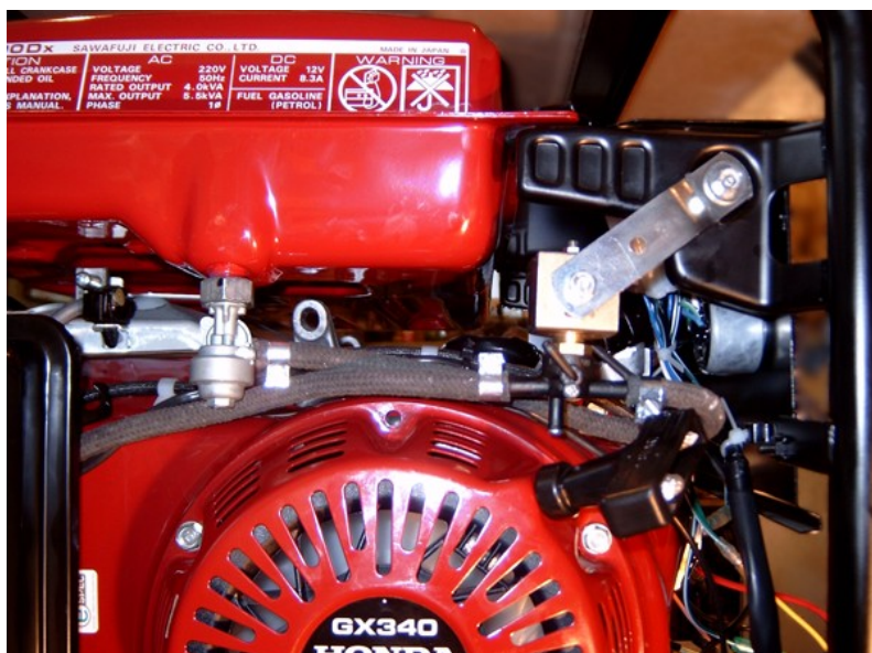
Рис. П1.11. Крепление бензоклапана на генераторных станциях HONDA и ELEMEX.
