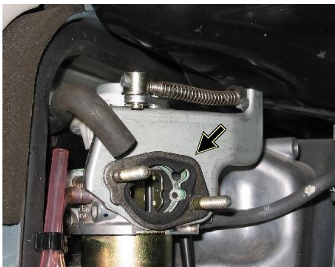
Рис. П2.2. Проставка с прокладкой.
