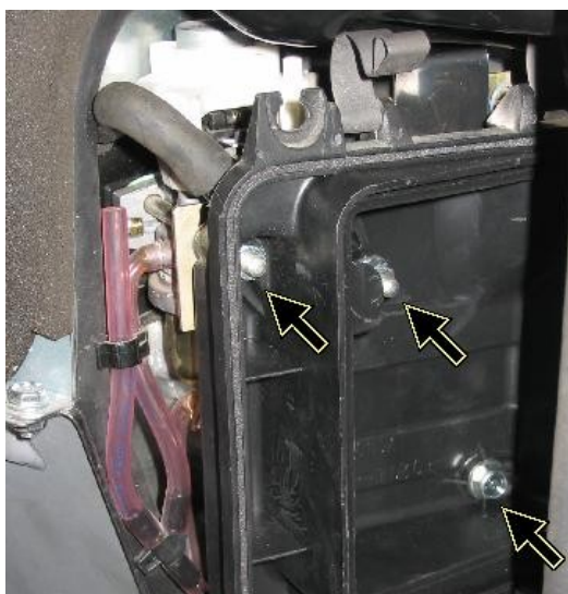
Рис. П2.1. Элементы крепления задней крышки воздушного фильтра.
