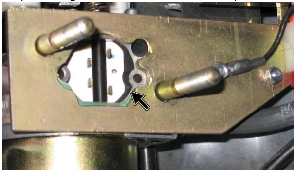
Рис. П2.10. Проверка зазора (показан стрелкой).
