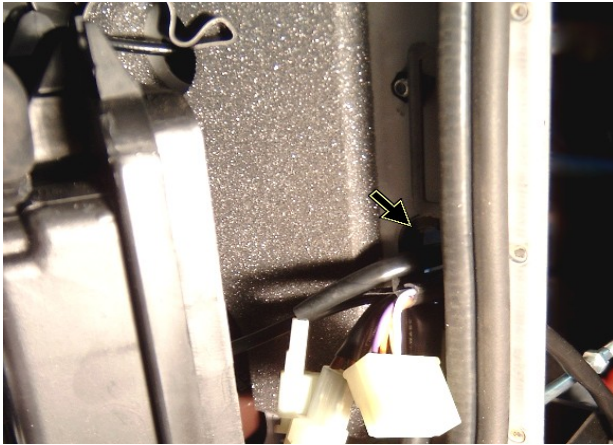
Рис. П2.5. Отверстие задней стенки передней панели и просунутые провода.
