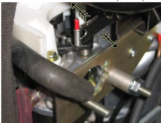
Рис. П2.11. Направления подстройки заслонки.
