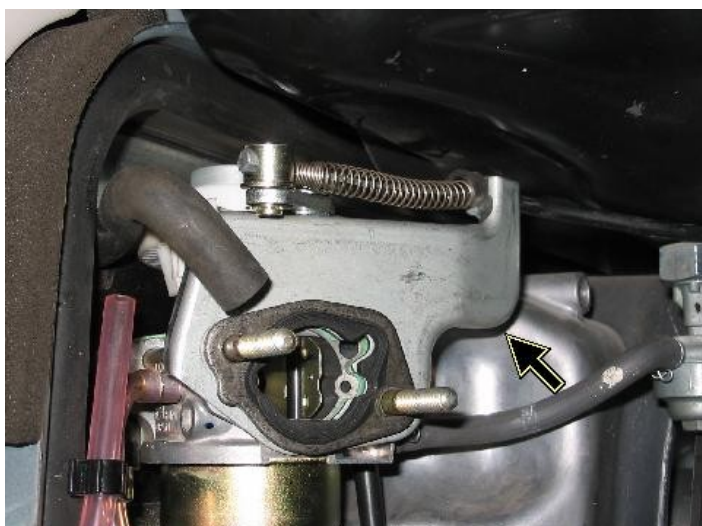
Рис. П2.3. Штатный ручной привод заслонки.
