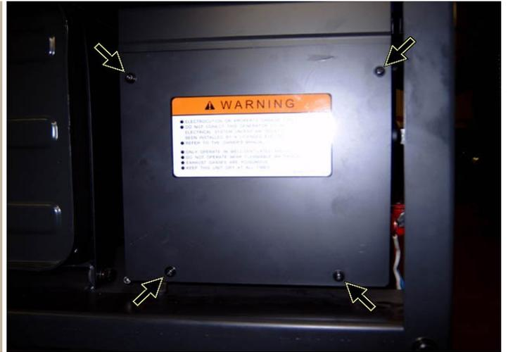
Рис.П2.2. Вит на боковую стенку блока управления (стрелками показаны места крепления)
