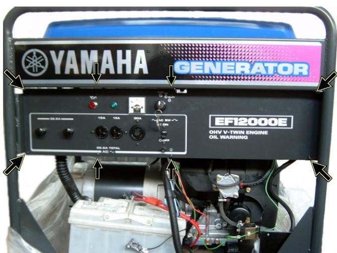
Рис.П2.8. Снятие передней панели.
