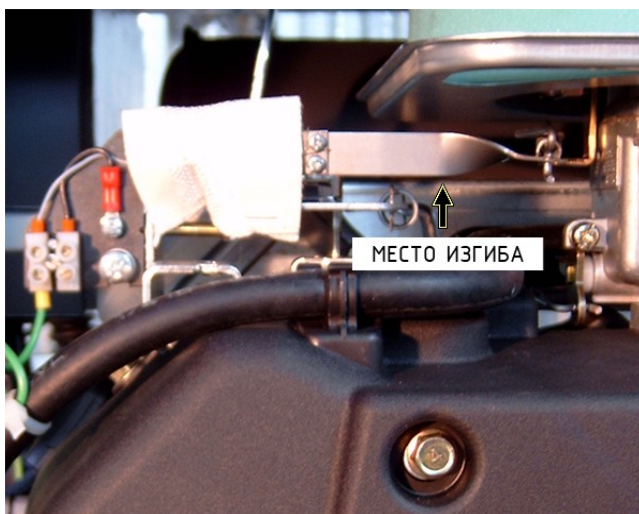
Рис.П2.4. и П2.5. Установленный привод на двухцилиндровых двигателях.
