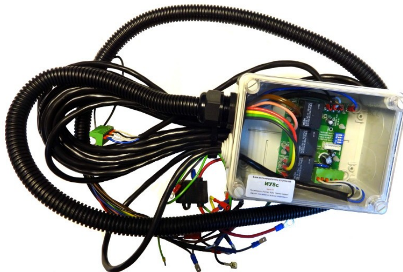
Рис.1 и 2. Блок электрики ИУ8с со жгутом и кабелем управления.
