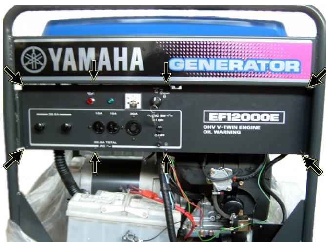
Рис. П1.3. Демонтаж передней панели.
