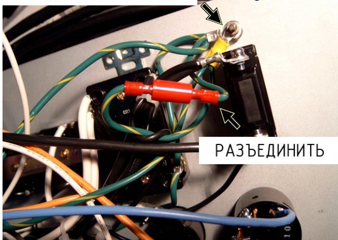
Рис. П1.5. Петля из зелёно-жёлтых проводов.
