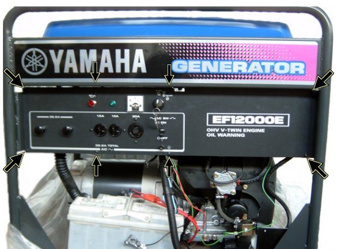
Рис.П2.8. Снятие передней панели.
