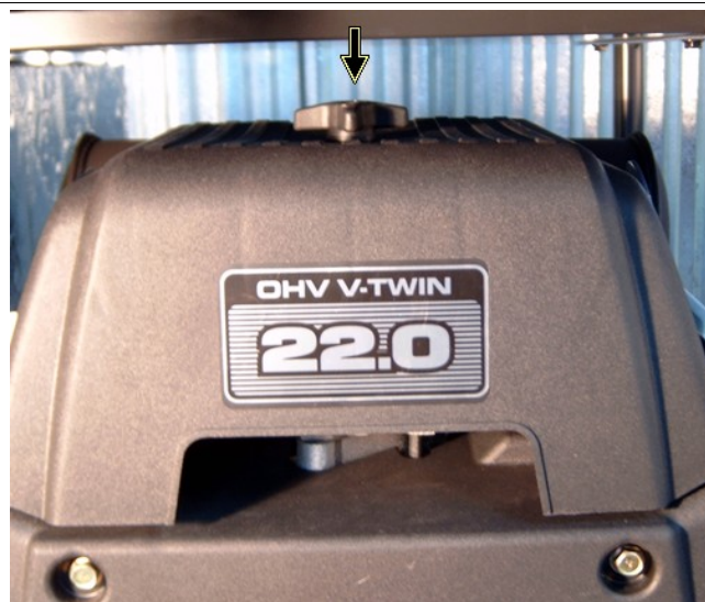
Рис. П2.1. Снятие фильтра на двухцилиндровых двигателях (стрелкой показана гайка крепления крышки воздушного фильтра).
