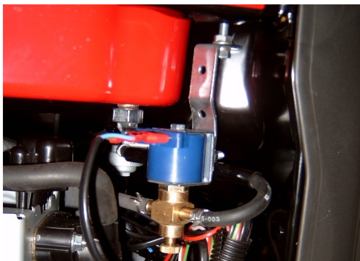
Рис.2.3.1. Вид на смонтированный топливный клапан.
