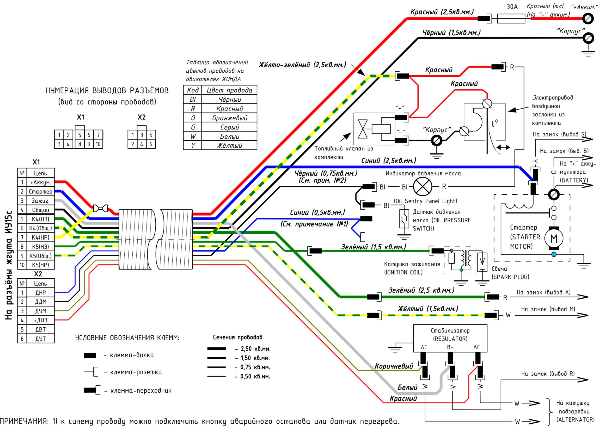
**Схема №1. Подключения жгутов к двигателям Kohler серий CH11 - CH15.**
