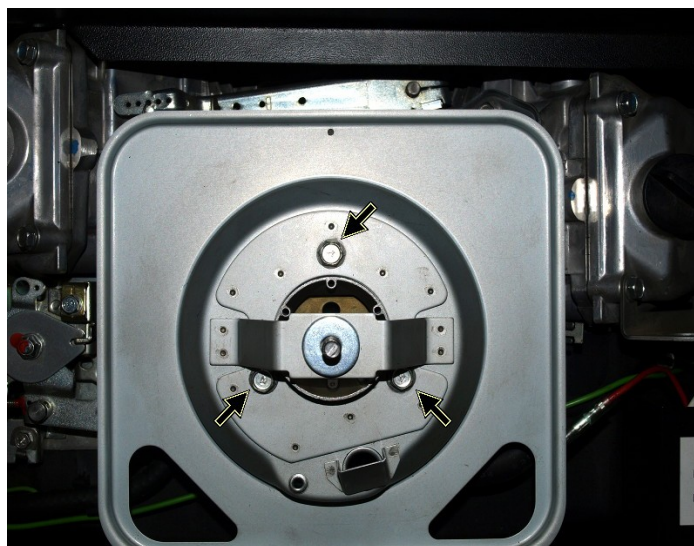
Рис.3. Открутите болты и снимите основание фильтра (стрелками показаны точки крепления).
