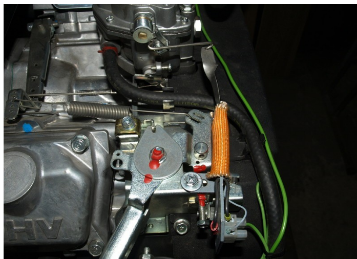
Рис.9. Вид на установленный привод воздушной заслонки ПБ8-2.
