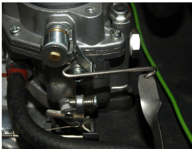
Рис.8. Вид на установленную тягу воздушной заслонки.
