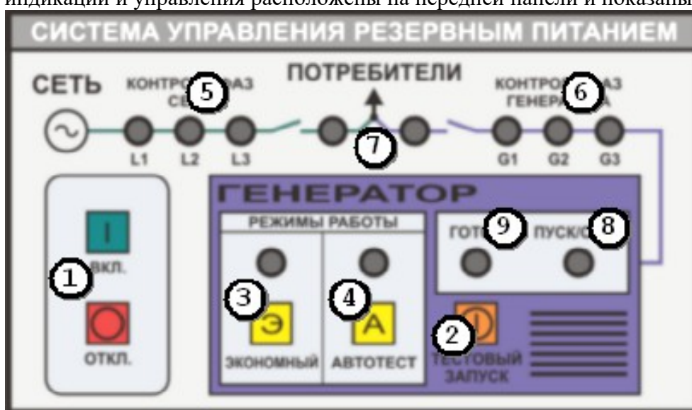
Рис.1. Органы управления и индикации на панели пульта RC3.
