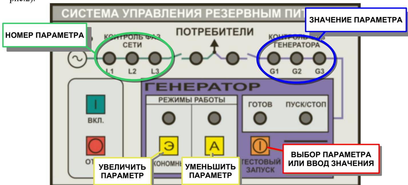
**Рис.2. Назначение кнопок и индикаторов в режиме изменения настроек.**
