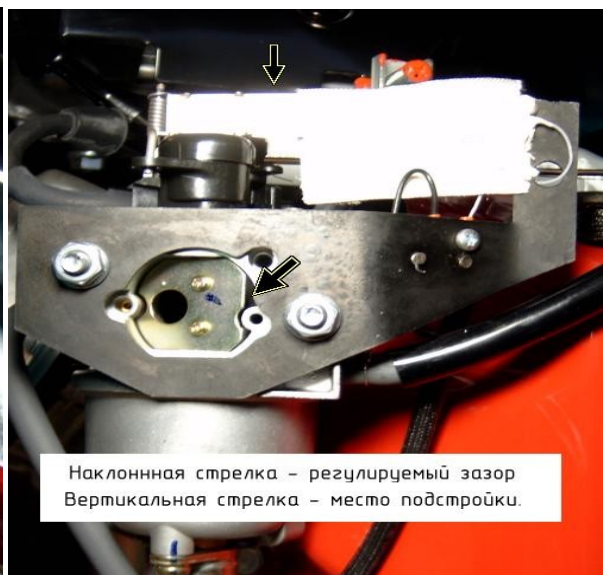
Рис.8. Подстройка зазора.
