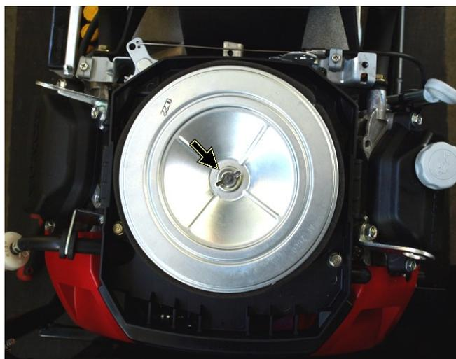
Рис.3. Открутите гайку и снимите фильтр.
