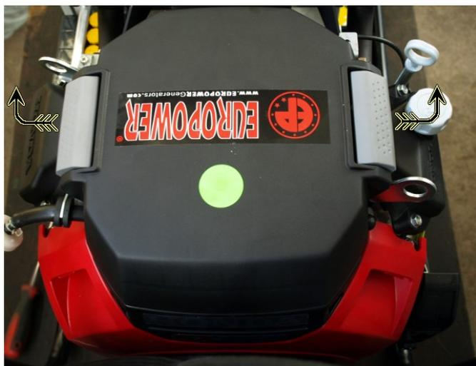
Рис.2. Снимите крышку воздушного фильтра.
