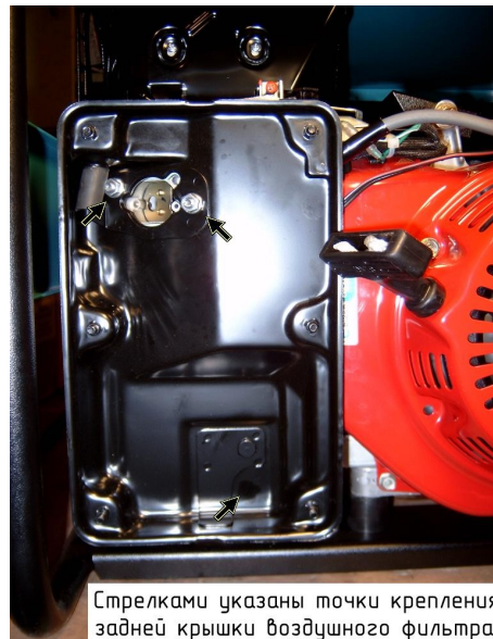
Рис. 2-4. Снятие фильтра на двигателях GX240-GX390.
