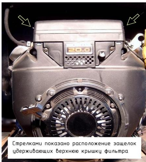
Рис.2 и рис.3. Снятие фильтра на двигателях GX240-GX390.
