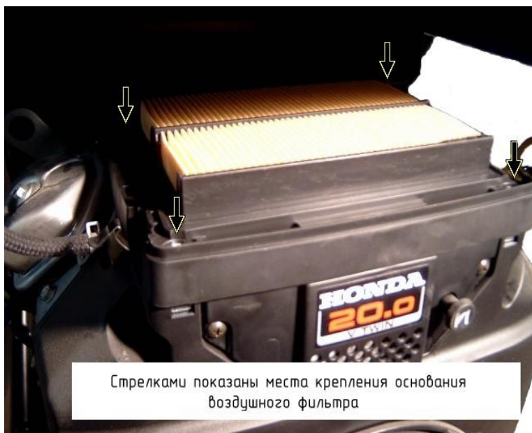
Рис.2 и рис.3. Снятие фильтра на двигателях GX240-GX390.
