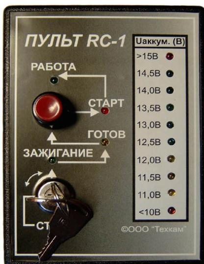
**Пульт РС-1 предназначен для осуществления дистанционного запуска и останова генераторной станции. Он будет полезен:**
