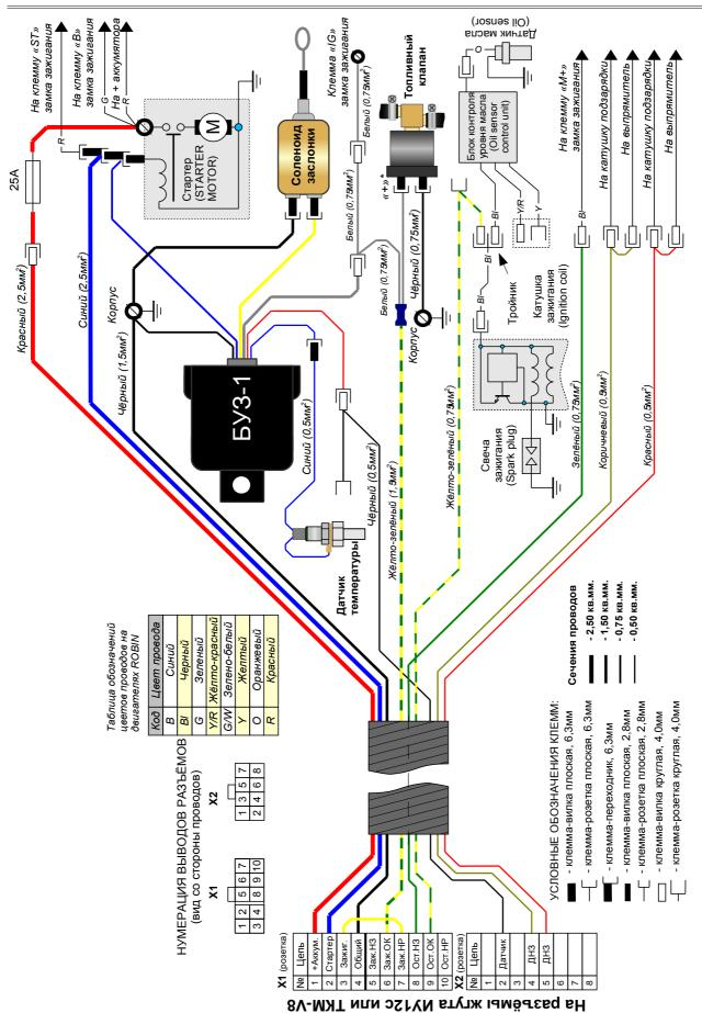
Схема подключения жгута ROBIN2.
