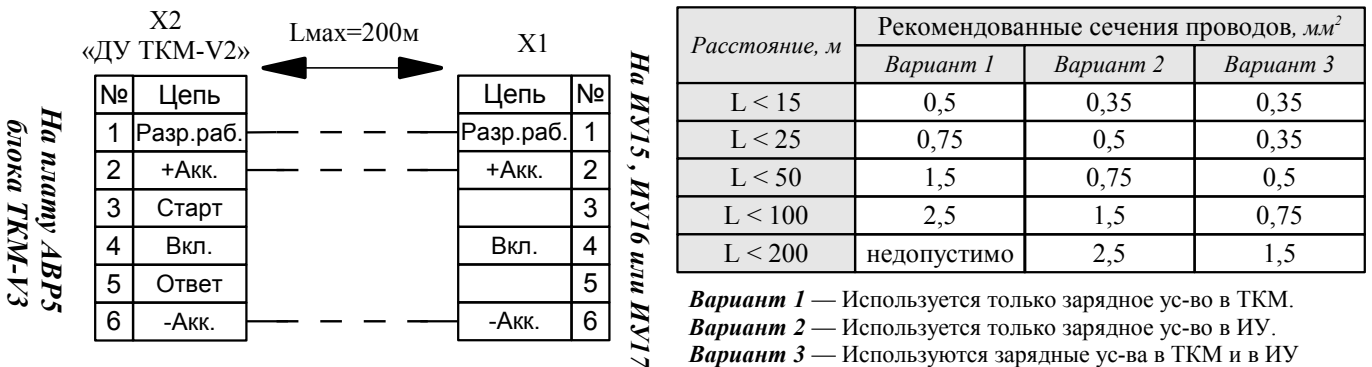
Рис.6. Варианты подключения исполнительного устройства серии ИУ15, ИУ16 и ИУ17.
