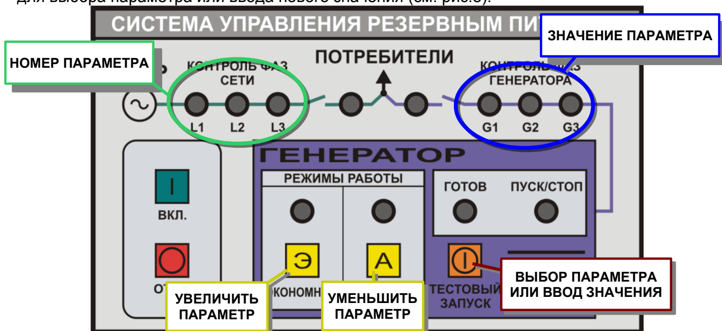
Рис.8. Назначение кнопок и индикаторов в режиме изменения настроек.
