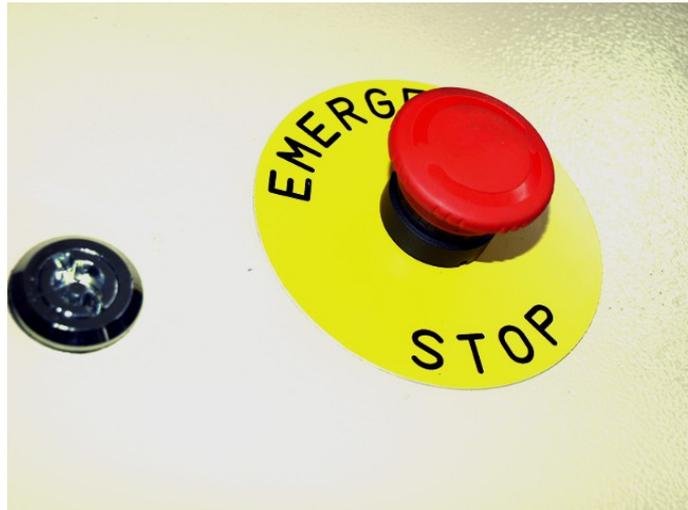
Рис.5. Установка шильдика и кнопки на дверцу.
