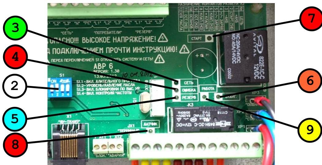
Рис.3. Органы управления и индикации на плате АВР6.
