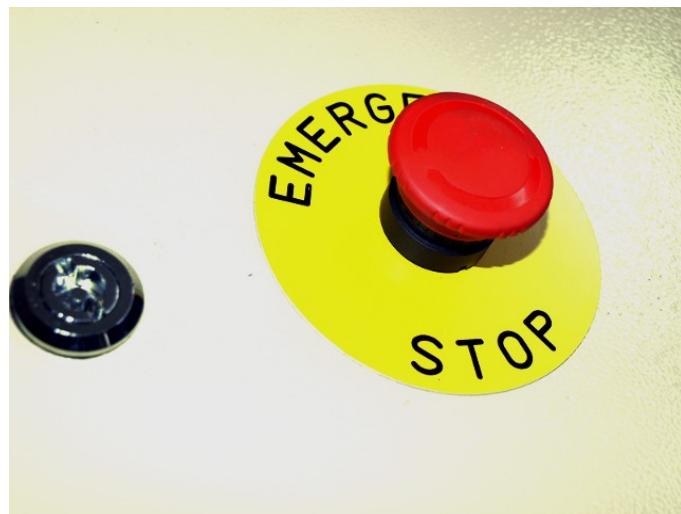
Рис.5. Установка шильдика и кнопки на дверцу.
