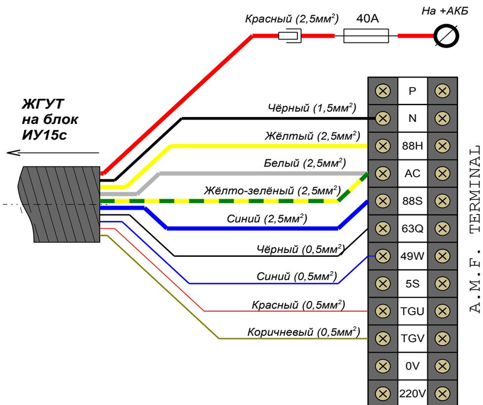
Схема 4. Подключение генераторов фирмы TOYO.
