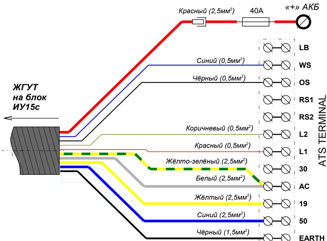
**Схема 2. Подключение генераторов фирмы KUBOTA**
