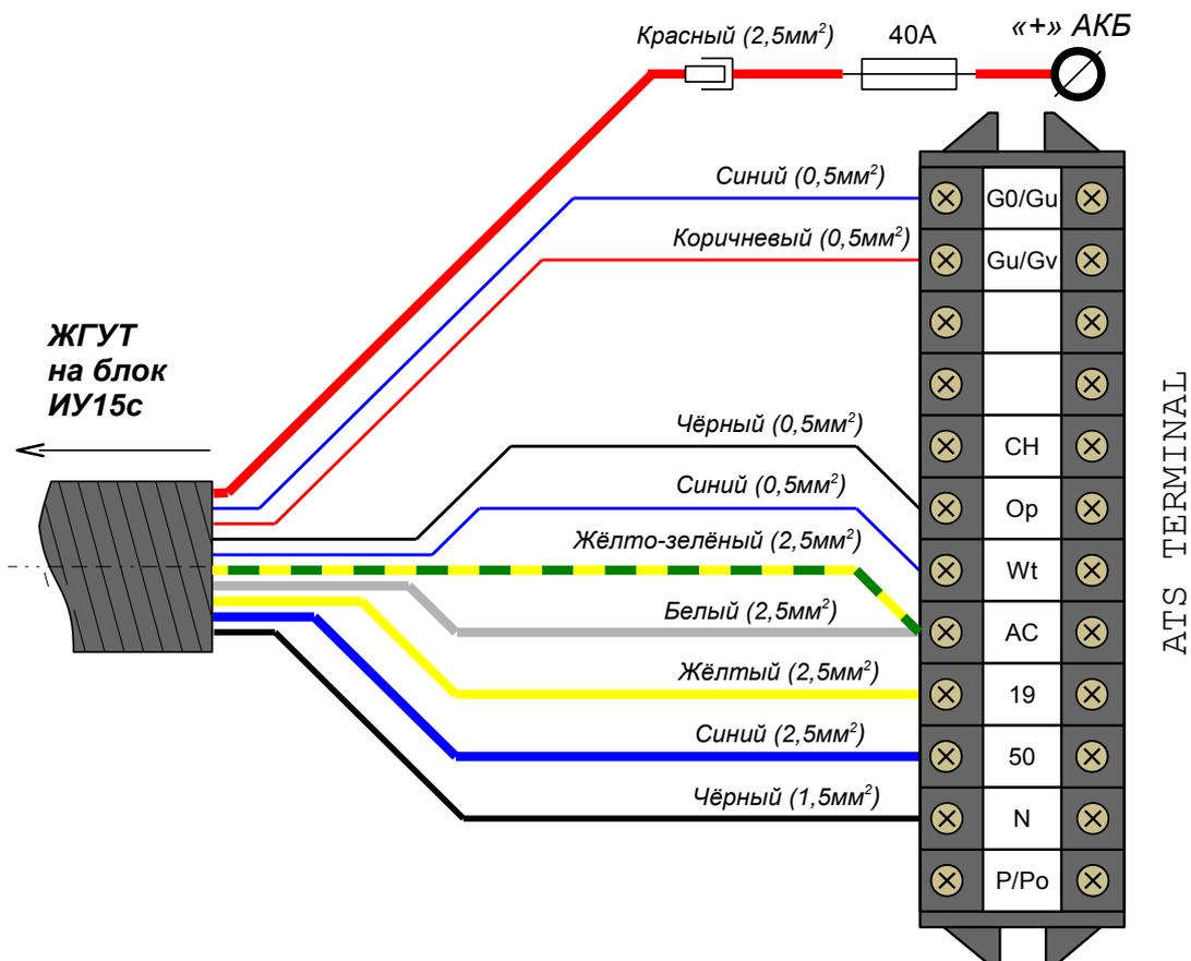
**Схема 3. Подключение генераторов EDL11000E, EDL13000TE, EDL16000E, EDL20000TE, EDL21000E, EDL26000TE фирмы YAMAHA.**
