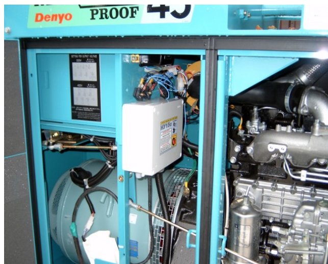
Рис. 5. Пример монтажа ИУ на борту ГС.
