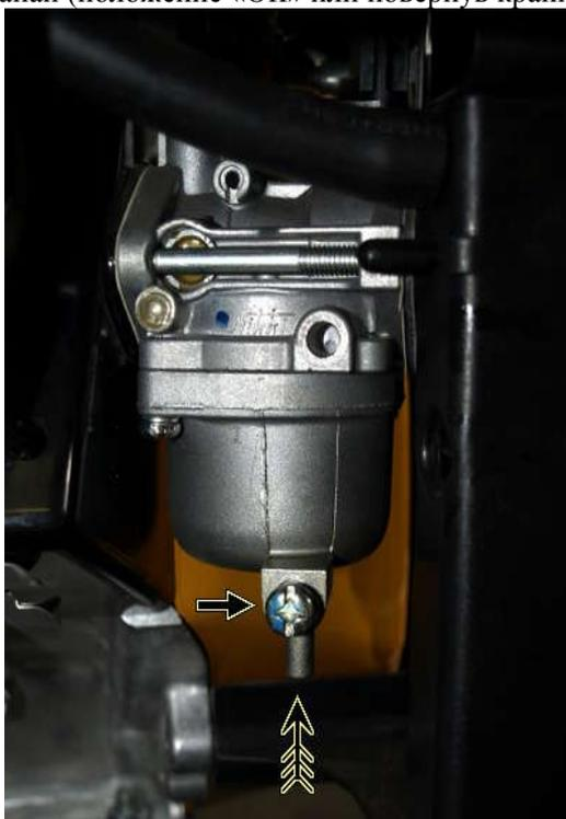
Ликвидация воздушной пробки в двигателях Robin-Subaru серии EX35, EX40.
