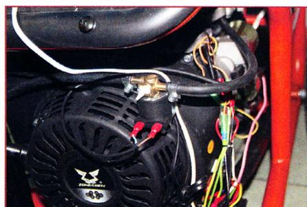
Электробензозапан ставится между баком и карбюратором, управляется автоматически. Возможно и ручное управление, для этого предусмотрен отдельный поворотный рычажок на клапане
