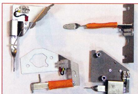
Небольшой, но важный элемент — электропривод воздушной заслонки карбюратора. Для разных моторов они различаются, некоторые типы с биметаллическим элементом представлены на фото
